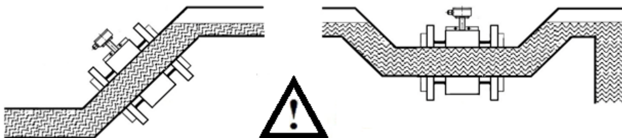
Рисунок 2. Расходомер полностью заполнен измеряемой жидкостью
