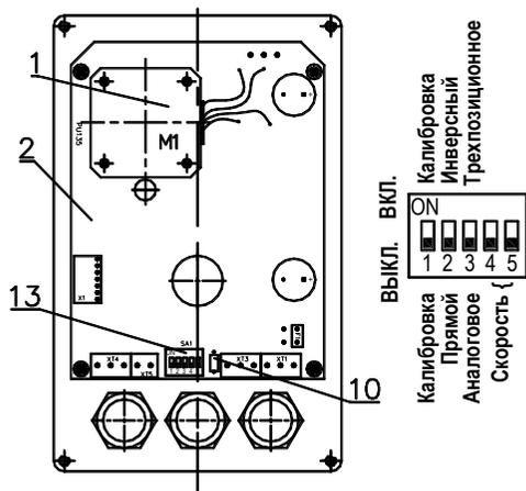
Рисунок 2 - ВЭП-138М (вид при снятой крышке)
